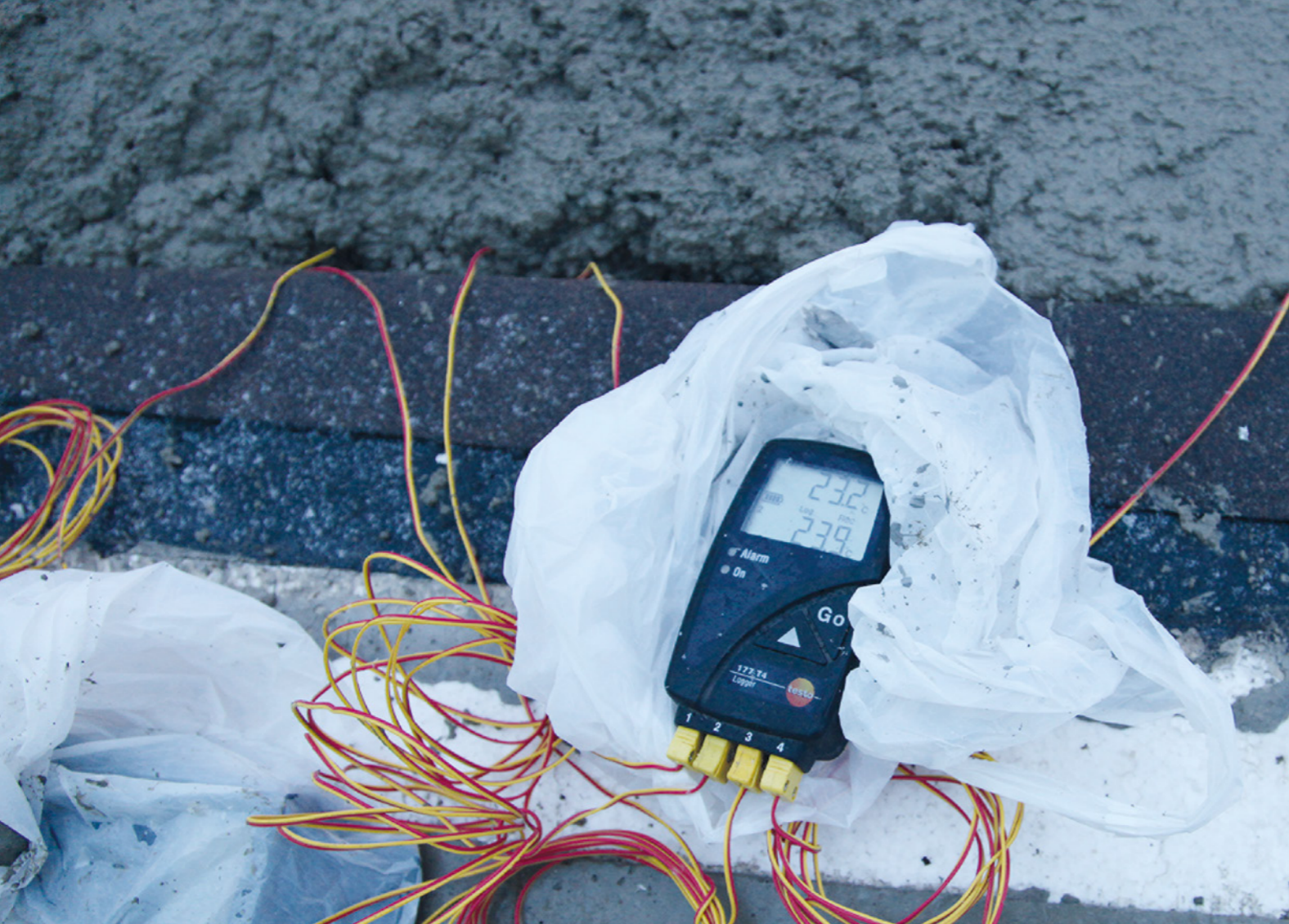
Lämpötilan seurantalaitte, 4-kanavainen datalogger
