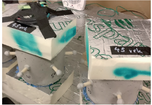
Kuva 14. Koekappaleet, joissa mittausputket ovat asennettuna.
