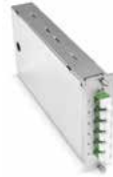
FO-DCS 3U/7HP plug-in -liitosmoduulit FO-DCS-kehikoille/modulaaripaneeleille, joissa on 12 häntäkuitua OM3, OM4, OS2 ja 6 LCD-sovittinta
